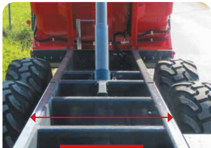
CHÂSSIS LARGE (1 160 MM) POUR UNE MEILLEURE STABILITÉ
