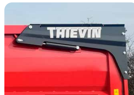
BRAS DE PORTE PLIÉ FLEXIBLES INTÉGRÉS DANS LES MONTANTS
