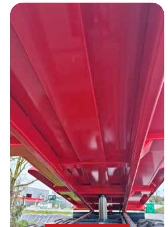
RENFORT DE FOND DE CAISSE SUR TOUTE LA LONGUEUR DE LA CAISSE
