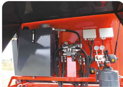
CENTRALE HYDRAULIQUE INDÉPENDANTE
