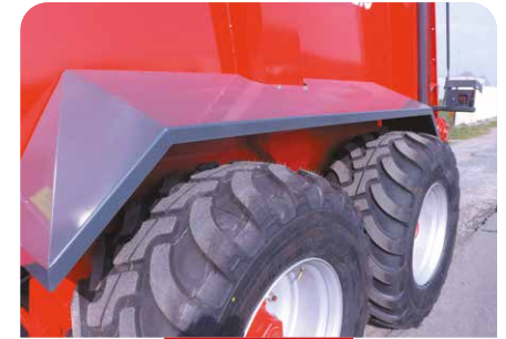
GARDE-BOUE SUR MARAL AVEC TANDEM À BIELLES
