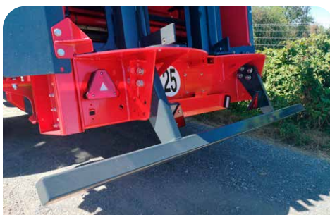
FEUX À LED BARRE ANTI ENCASTREMENT
