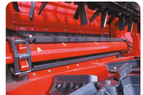
CHAÎNES PLATES AVEC BARETTES DÉMONTABLES
