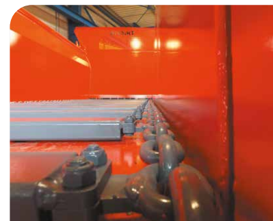
TAPIS DE CHAÎNES TRAVAILLANT AU RAZ DE LA CAISSE
